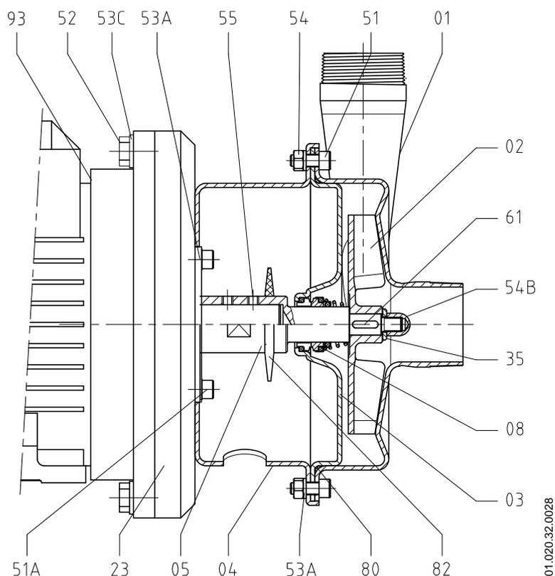
9.10. СПИСОК ДЕТАЛЕЙ НАСОСА ESTAMPINOX EFI 3 С ДВИГАТЕЛЕМ РАЗМЕРА 132
