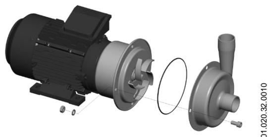
3. Зафиксировать вал (05) в неподвижном положении, разместив неразводной ключ на плоских гранях вала (05). Для насоса ESTAMPINOX EFI 3 поместить шпильку в отверстие вала (05).
